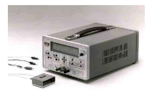
E' uno strumento progettato e realizzato per misure accurate di resistenza e di corrente. L'impiego della tecnologia digitale a microprocessore, abbinata a circuiti analogici avanzati, permette precisione, versatilità e semplicità d'uso. Il suo impiego industriale, completa la gamma di strumentazione LAEL per collaudi di accettazione, misure di laboratorio e produzione.
